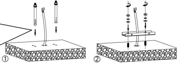
**ATTENZIONE: Avvitare con forza per garantire adeguato grado di protezione IP ad acqua ed umidità**
