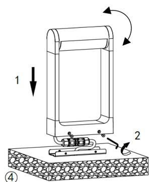
**ATTENZIONE: Per garantire il grado di protezione IP utilizzare un cavo tipo H05RN-F per il collegamento alla rete di alimentazione.**
