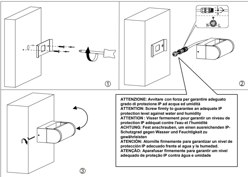
**ATTENZIONE: Avvitare con forza per garantire adeguato grado di protezione IP ad acqua ed umidità**
