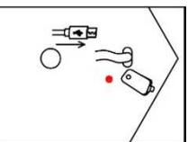
2- Utilisez le câble fourni en l'insérant dans le port USB-C et en connectant l'autre extrémité à une prise USB alimentée (5V, 1A).
